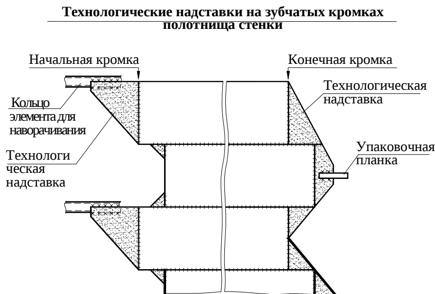
Рис.16.2б - Технологические надставки на кромках полотнища стенки
